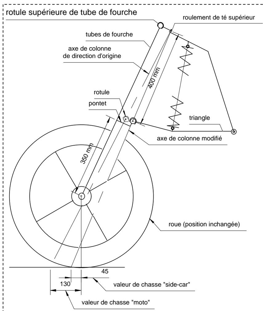
A noter qu'un pneu renforcé 130/70-17 remplace le pneu d'origine à l'avant et concilie sécurité, esthétique, agrément de conduite et longévité (15 000 kms et plus) ; car le point fort de cette solution, c'est bien l'agrément de conduite :
